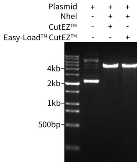
图1. 碧云天生产的BeyoFast™ NheI (D5809)酶活性实测效果图。20μl反应体系中包含1μg pCMV-Blank (D2602) (4294bp), 以及如图所示不添加或添加1μl BeyoFast™ NheI, 分别使用1X CutEZ™ Buffer和1X Easy-Load™ CutEZ™ Buffer, 37°C孵育15分钟进行酶切反应, 随后65°C孵育20分钟使酶失活, 然后电泳并使用NA-Red (EB升级换代产品, 2000X) (D0128/D0130)进行核酸染色和荧光成像分析。所使用的DNA marker为DNA Ladder (0.2-12 kb, 12 bands) (D0110)。实际检测效果会因实验条件、检测仪器等的不同而存在差异, 图中效果仅供参考。
